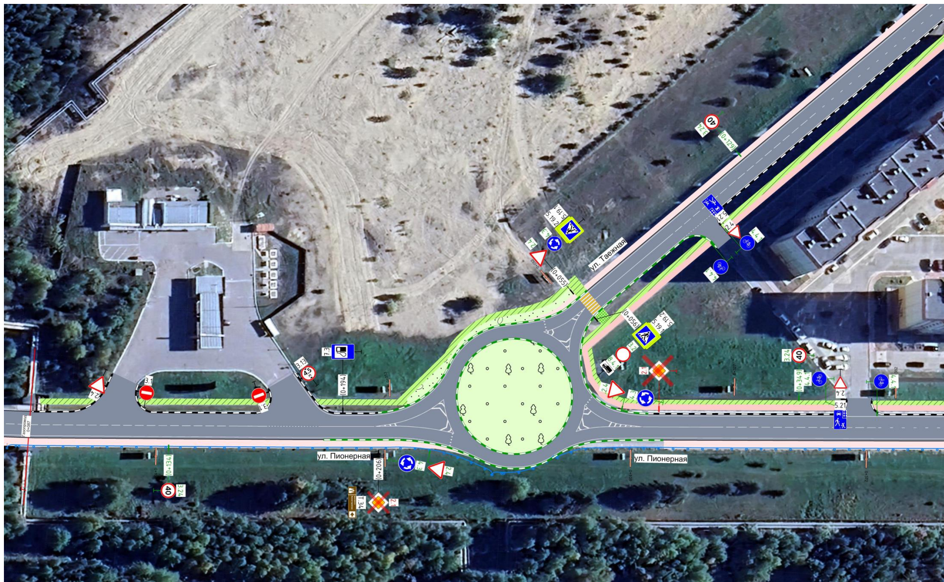
Рисунок 3.3 – Схема ОДД на пересечении ул. Пионерная – ул. Таежная (вариант с кольцевым пересечением)
