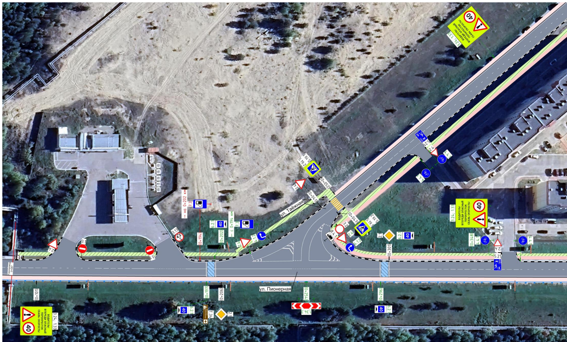
Рисунок 3.2 – Схема ОДД на пересечении ул. Пионерная – ул. Таежная (бюджетный, «быстрый» вариант)
